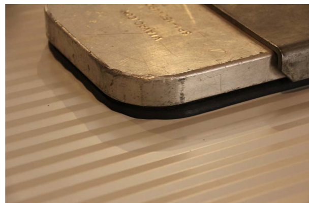
Zdjęcie nr 4. Niskoprofilowa przysawka urządzenia próżniowego. Elastyczna uszczelka obwodowa przysawki po wytworzeniu podciśnienia zapewnia podparcie na całej powierzchni styku przysawki z płytą warstwową.
