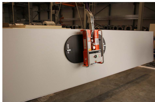
Zdjęcie nr 2. Urządzenie próżniowe z przysawką centralną.
